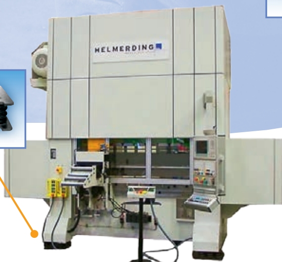
Presse, gelagert auf Federisolatoren
